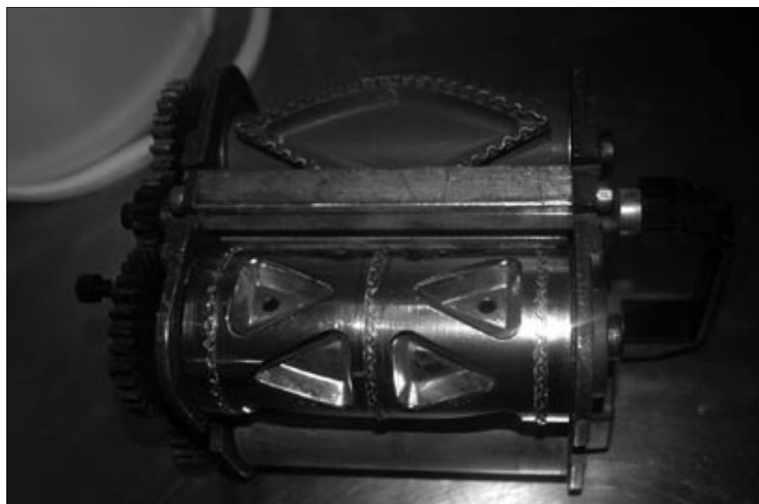
Cylindre pour la production de raviolis: Il s'installe facilement dans la machine. (photo hs)
